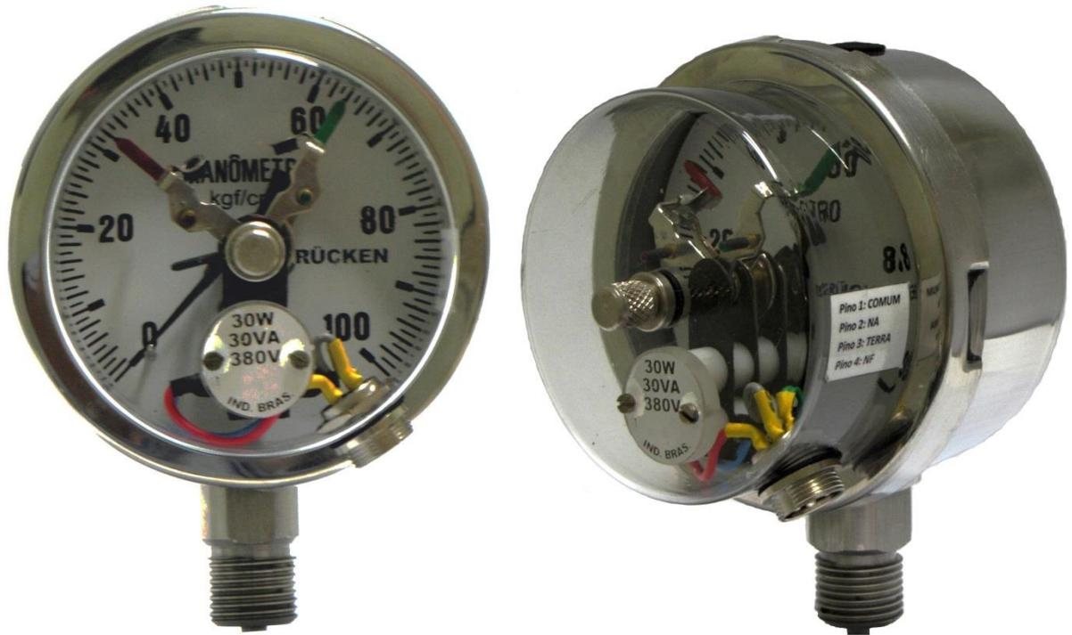
Os Manômetros com contato elétrico **RÜCKEN** modelo **RM-CE**, como o próprio nome diz, são fabricados com um ou com dois contatos elétricos: NA ou NF. São construídos totalmente em aço inox AISI 304 ou AISI 316 para o mecanismo e partes em contato com o fluido (soquete e tubo bourdon), como também podem ser fabricados com a caixa em aço carbono e os internos em ligas de latão.
