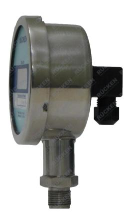
O Transmissor e Indicador de Pressão **RÜCKEN** Modelo **RMD-420**, utiliza a tecnologia do sensor Piezoresistivo, convertendo e amplificando o sinal emitido, para uma grandeza diretamente proporcional em corrente ou tensão, ou seja, modulando os ranges de pressão em sinais elétricos conhecidos, dos principais sistemas de leituras analógicas.
