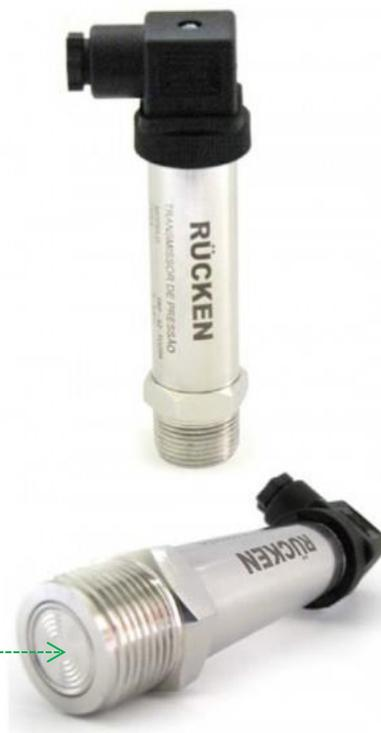
O Transmissor de Pressão **RÜCKEN** modelo RTP-420-MR, fabricado com uma membrana rasante, atuando como um “diafragma”, construída em inox AISI 316 evitando incrustações. Utiliza a tecnologia do sensor Piezoresistivo, convertendo e amplificando o sinal emitido, para uma grandeza diretamente proporcional em corrente ou tensão, ou seja, modulando os ranges de pressão em sinais elétricos conhecidos, dos principais sistemas de leituras analógicas.
