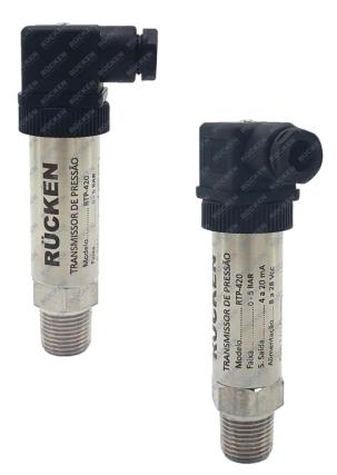
O Transmissor de Pressão **RÜCKEN** modelo **RTP-420**, utiliza a tecnologia do sensor Piezoresistivo, convertendo e amplificando o sinal emitido, para uma grandeza diretamente proporcional em corrente ou tensão, ou seja, modulando os ranges de pressão em sinais elétricos conhecidos, dos principais sistemas de leituras analógicas.
