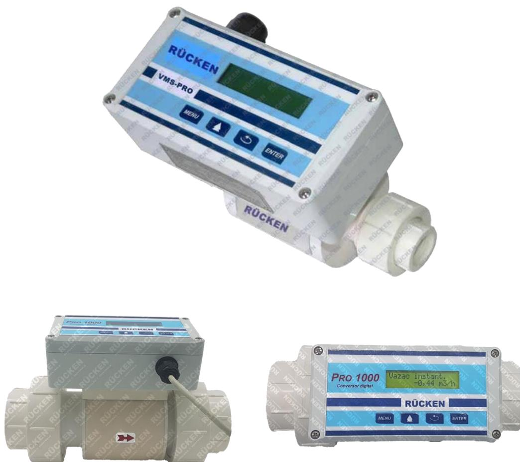
O medidor eletromagnético de vazão **RÜCKEN** modelo R-VMS PRO é fabricado totalmente em PVC. Com tecnologia SMT, traz incorporado no cabeçote display de cristal líquido para indicação da vazão instantânea/totalizada e 4 teclas de parametrização rápida e amigável.
