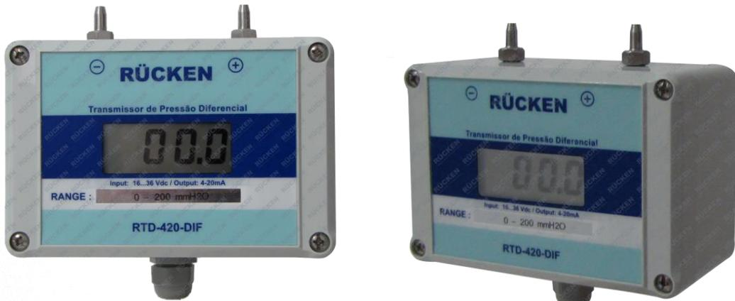
O Transmissor e Indicador de Pressão diferencial **RÜCKEN** Modelo **RTD-420-DIF**, utiliza a tecnologia silicon sensor chip, convertendo e amplificando o sinal emitido, para uma grandeza diretamente proporcional em corrente ou tensão, ou seja, modulando os ranges de pressão em sinais elétricos conhecidos.
