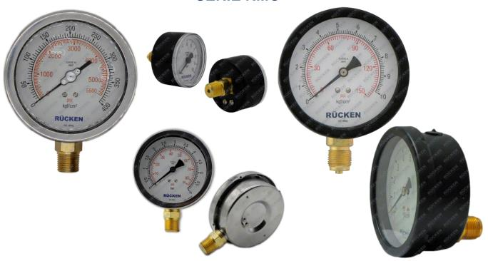
Os Manômetros **RÜCKEN** da Série **RMC**, são construídos com caixa em aço carbono, ou latão forjado, ou em aço inox AISI 304. Mecanismo, soquete e tubo bourdon em ligas de latão ou tomback. São aplicados em indústrias de qualquer natureza, podendo operar com gases ou líquidos, desde que sejam compatíveis e não agressivos as ligas de latão e soldas de estanho.
